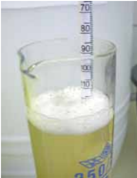
Der Zuckergehalt wird mit einer Oechslewaage kontrolliert und eingestellt.
