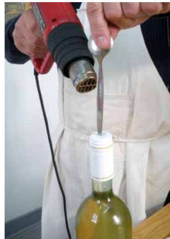
Beim Erwärmen schmiegen sich die Verschlusskapseln um den Flaschenhals. Fotos: Autor, J. Schwenkel (1)
